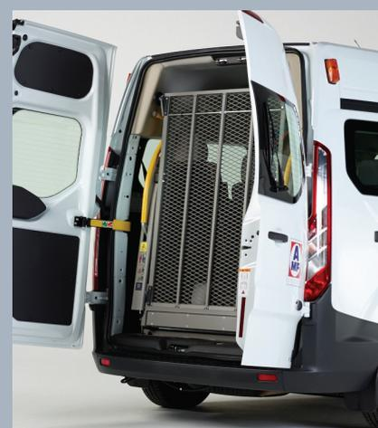
Das durchsichtige Plattformdesign des Linearliftes sorgt für eine exzellente Sicht nach hinten.
