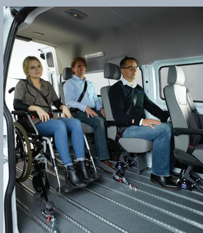
Durch den Smartfloorboden ist die flexible Beförderung von „Läufern“ und Rollstuhlnutzern kein Problem.
